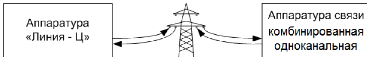
Рисунок 16 – Подключение АКСТ «Линия-Ц» - АСК-1 или АСК-3
