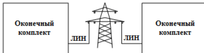
Рисунок 1 – Схема включения основного комплекта АКСТ РЗПА «Линия-Ц»
